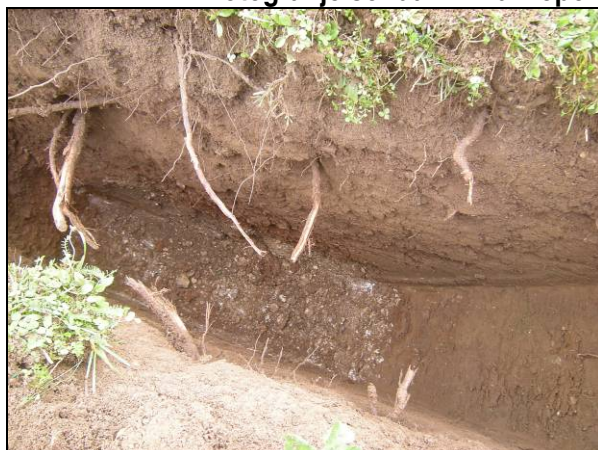
Razkop S1: zgoraj humus in rjava meljasta glina s koreninami, spodaj zaglinjen prod, na dnu svetlosiv peščeno meljast prod.
