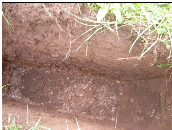
Razkop S2: zgoraj humus in rjava meljasta glina s koreninami, na dnu svetlosiv peščeno meljast prod.
